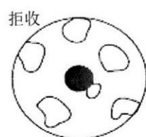
图3 超过玻璃封装面积 1/3 的气泡
